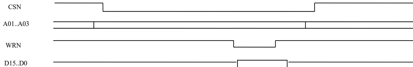
Рисунок 5 - Временная диаграмма чтения в режиме контроллера
