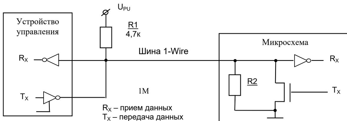
Рисунок 10 – Конфигурация 1-Wire шины
