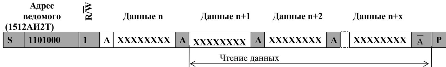
Рисунок 6 - Чтение данных без предварительной записи начального адреса чтения
